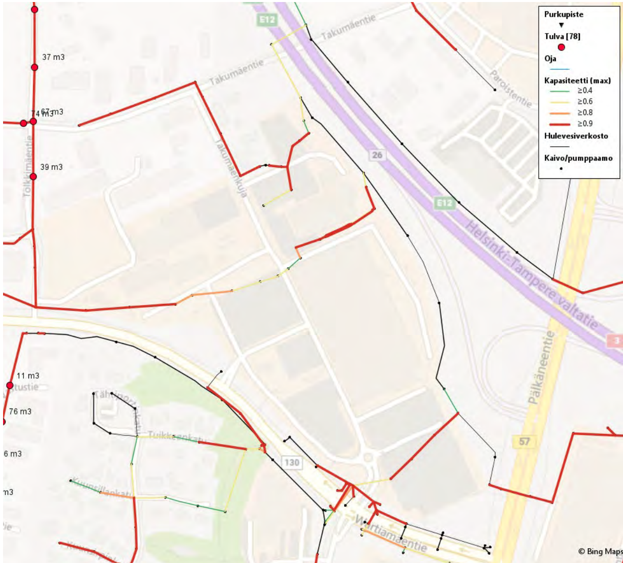
Kuva 14. Hulevesiviemärin ja ojien kapasiteetti mitoitussateella nykytilassa.
