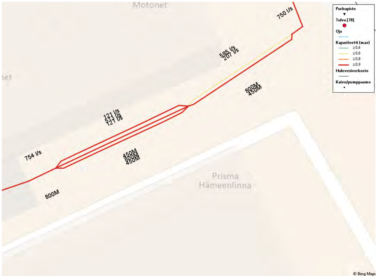
Kuva 19. Nykyisen viivytyksen kapasiteetti, putkikoot ja virtaamat.
