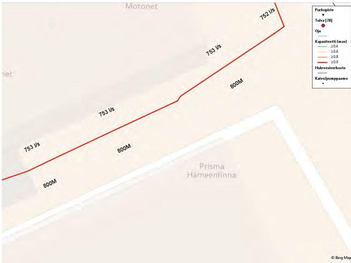
Kuva 20. Kuvitteellisen verkoston kapasiteetti, putkikoot ja virtaamat.
