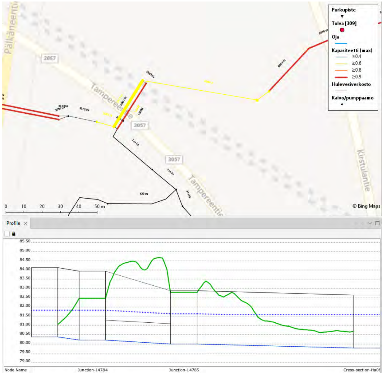
Kuva 18. Tampereentien ja rautatien toisen alittavan rummun pituusleikkaus 1/100a.
