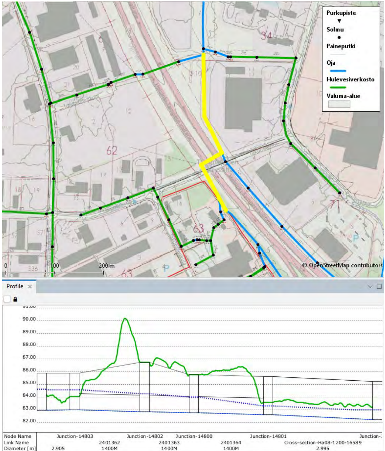
Kuva 17. Helsinki-Tampere valtatie alittavan rummun pituusleikkaus 1/100a.
